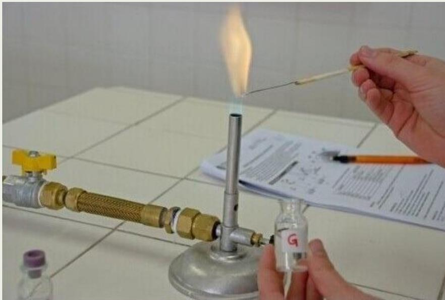
**Bico de Bunsen** é um queimador de gás usado correntemente no laboratório como fonte de aquecimento. Este funciona por combustão completa de gases (hidrocarbonetos), nomeadamente de propano ( $C_3H_8$ ) ou de butano ( $C_4H_{10}$ ) ou de ambos
